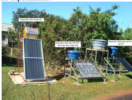
Figura 2: Equipamentos de Aquecedor Solar Instalados no Campo Experimental
